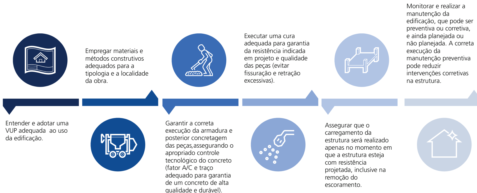
Figura 6.6 6 momentos importantes no projeto, na execução e na manutenção da edificação
