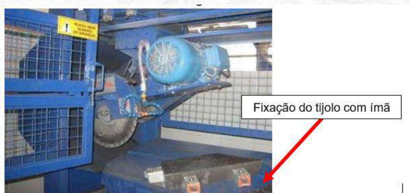
Fig. B.1 – Serra exclusiva para refratários com proteções e dispositivos para fixação do tijolo.
